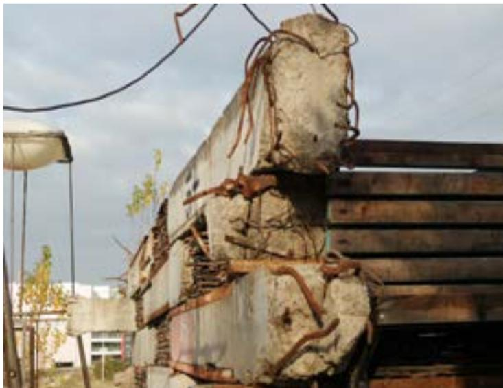
*Fig. 13 - Expérimentation à l'Actlab avec les anciens poteaux béton du magasin Printemps
